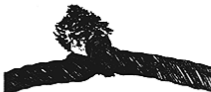
14-расм.Пўлат арқон буралиб кетиши
