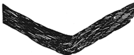
16-расм. Пўлат арқоннинг ҳаддан ташқари букилиши
