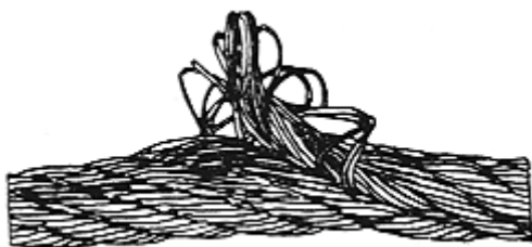
10-расм. Ўртачасининг сиқиб чиқишида
